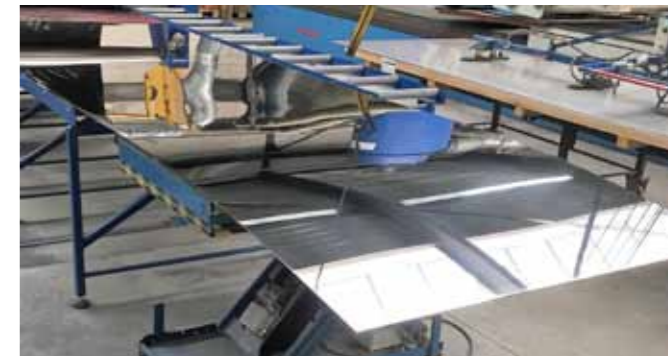
Voor ligt een hoogglans gepolijste plaat. Daarachter ligt onbewerkte plaat voor het polijsten.
